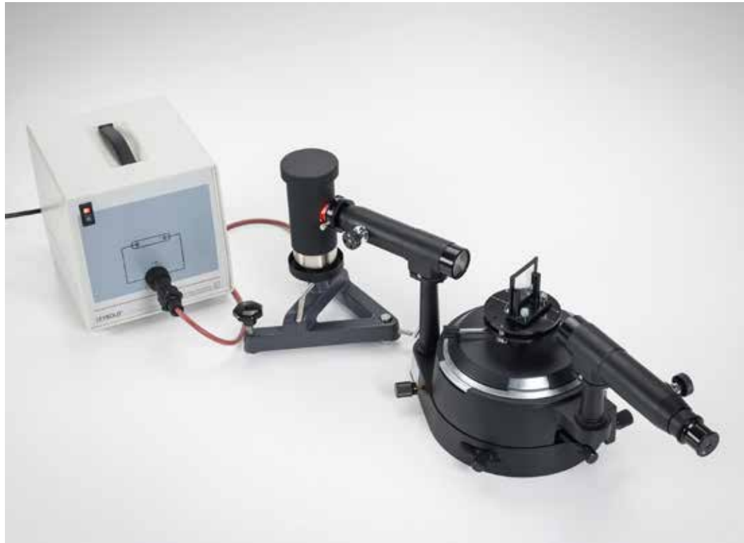
Medición de las líneas espectrales de gases nobles y vapores metálicos con un espectrómetro de rejilla (P5.7.2.1)
