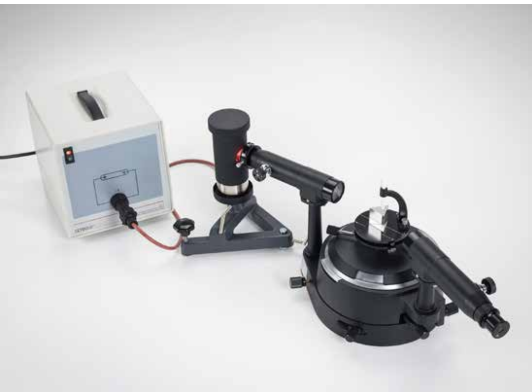
Medición de las líneas espectrales de gases nobles y vapores metálicos con un espectrómetro de prisma (P5.7.1.1)
