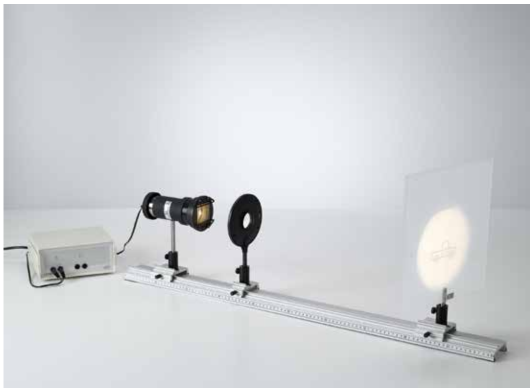
Verificación de la ley de proyección de imágenes con una lente condensadora (P5.1.2.4)
