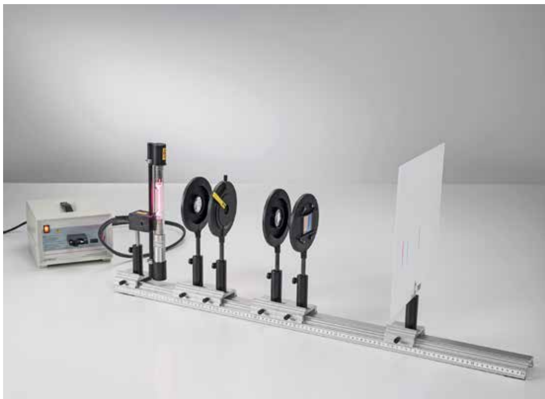
Determinación de las longitudes de onda H_\alpha , H_\beta y H_\gamma de la serie de Balmer del hidrógeno (P6.2.1.1)
