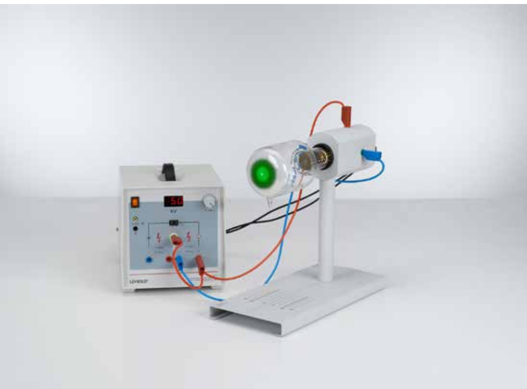
Difracción de electrones en una red policristalina (difracción de Debye-Scherrer) (P6.1.5.1)
