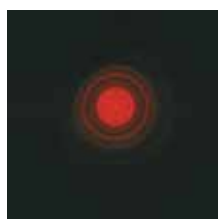
Análogo óptico de la difracción de Debye-Scherrer (P6.1.5.2)
