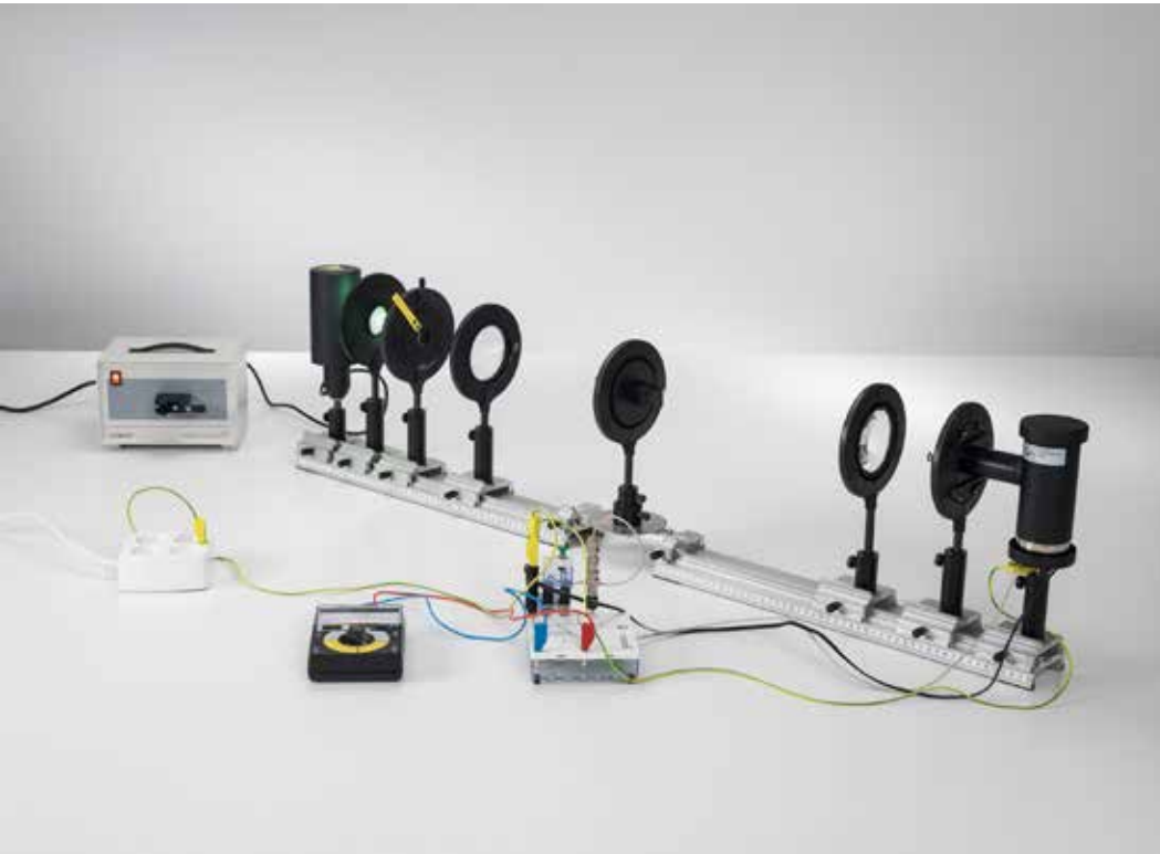
Determinación de la constante de Planck - Descomposición en longitudes de onda con un prisma de visión directa sobre el banco óptico (P6.1.4.2)
