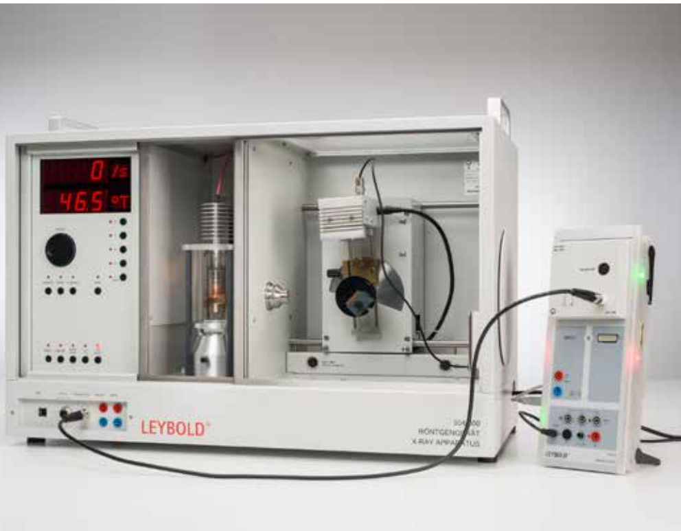
Aplicación de la fluorescencia de los rayos X en el análisis no destructivo de la composición química (P7.5.1.1)
