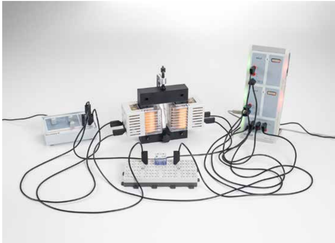
Registro de la curva de la primera imantación y la curva de histeresis de un material ferromagnético y hierro (P7.3.2.1)
