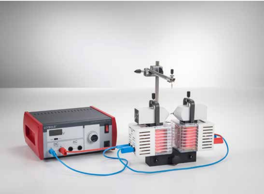
Materiales diamagnéticos, paramagnéticos y ferromagnéticos en un campo magnético no homogéneo (P7.3.1.1)
