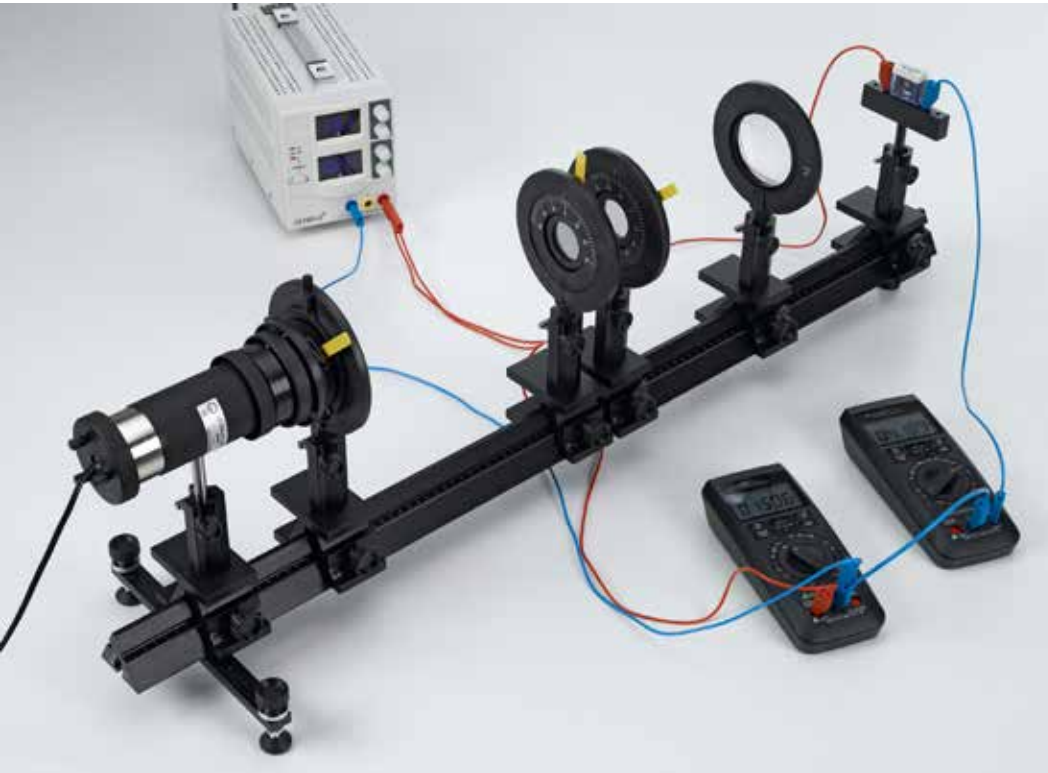
Registro de la curva característica corriente y tensión de una fotorresistencia de CdS (P7.2.3.1)
