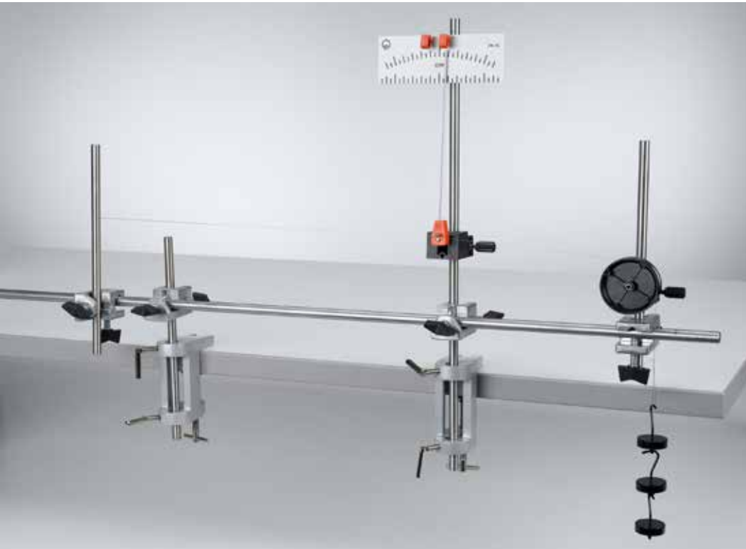
Estudio del estiramiento elástico y plástico de alambres metálicos (P7.1.4.1)
