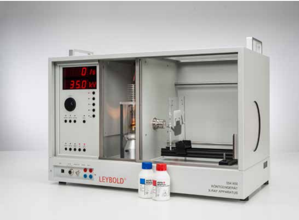
Método de Laue: Estudio de la estructura cristalina de monocristales (P7.1.2.2)
