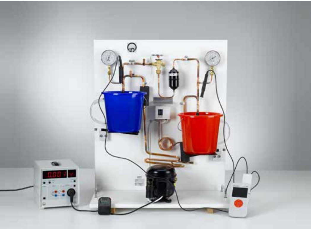
Determinación del índice de rendimiento de la bomba térmica en función de la diferencia de temperaturas (P2.6.3.1)
