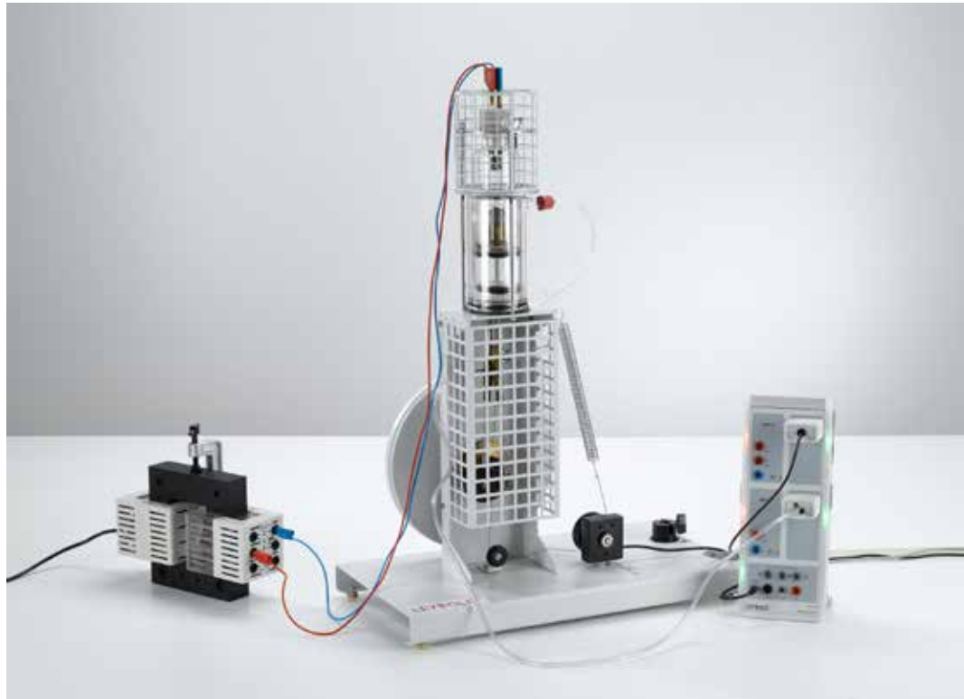
El motor de aire caliente como máquina térmica: Registro y evaluación del diagrama pV con CASSY (P2.6.2.4)
