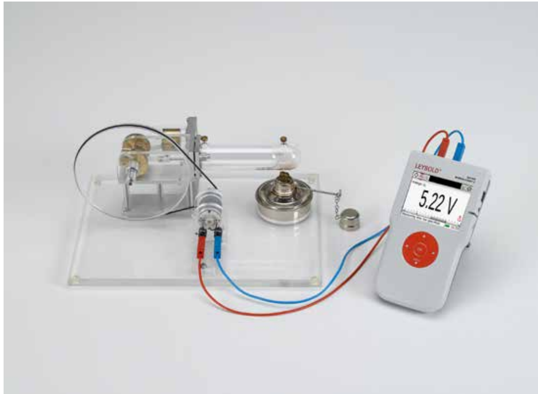
Funcionamiento del motor de aire caliente P como máquina térmica, bomba térmica y máquina frigorífica (P2.6.1.5)
