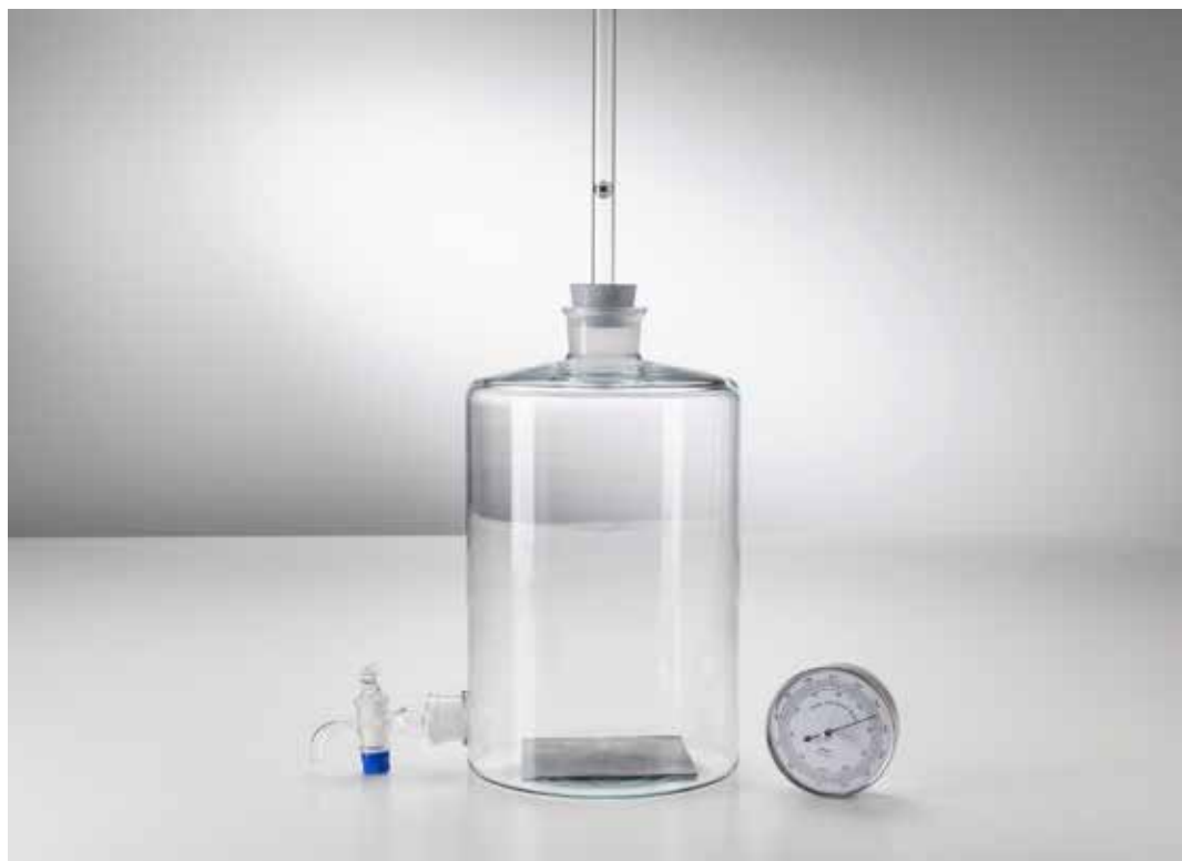
Determinación del exponente adiabático c_p/c_v del aire según Rüchardt (P2.5.3.1)
