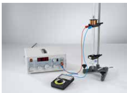
Determinar el exponente adiabático c_p/c_v de varios gases utilizando el aparato de resonancia elástica de gases (P2.5.3.2).
