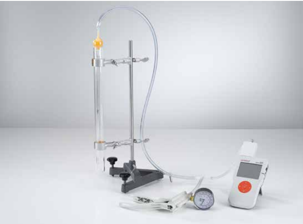
Dependencia del volumen de un gas con respecto a la presión a temperatura constante (Ley de Boyle-Mariotte) (P2.5.2.1)
