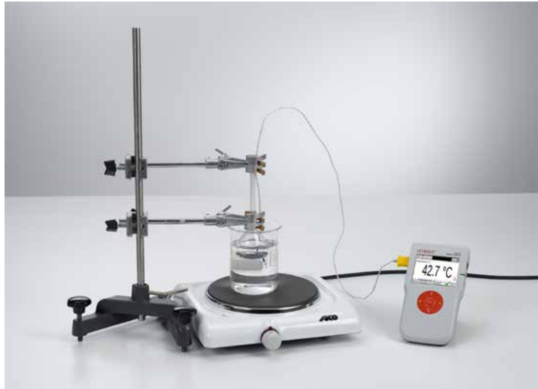
Determinación de los coeficientes de dilatación volumétrica de líquidos - Medición con Mobile-CASSY (P2.1.2.2)
