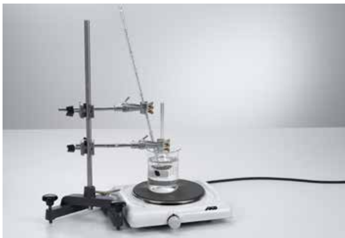
Determinación del coeficiente de dilatación volumétrica de los líquidos (P2.1.2.1)
